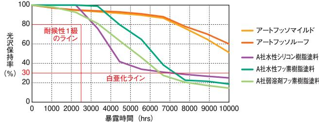
他社フッ素樹脂塗料と比較して、きわめて高い耐候性能を有しています。
