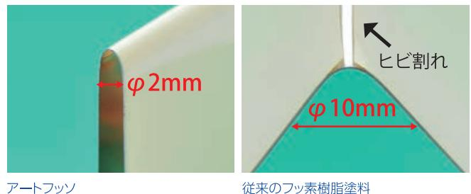
従来のフッ素樹脂塗料はφ10mmの曲げ試験でひびが入りますが、アートフッソは、φ2mmでもひび割れが起きません。
